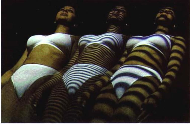
شكل (٢٠٥): يوضح طريقة لويكس وولسون ترايفورم وإلقاء الكاميرا الضوء على الجسم في شكل شرائح ضيقة وعريضة
