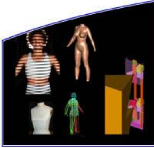
شكل (٢٠٧): طريقة T.C. ومراحلها لعمل مسح ثلاثي الأبعاد للجسم
