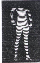
شكل (٢٠٥): يوضح طريقة لويكس وولسون ترايفورم وإلقاء الكاميرا الضوء على الجسم في شكل شرائح ضيقة وعريضة
